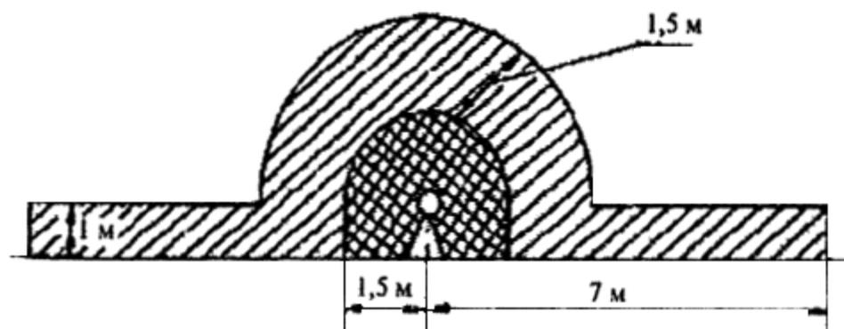
Рис.8. Открытые пространства вокруг окончания труб, отводящих попутные газы (а), и отверстий для выпуска газов (паров) из закрытых технических устройств (в).
