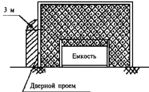
Рис.1. Открытые емкости, аппараты, устройства в открытом помещении.
