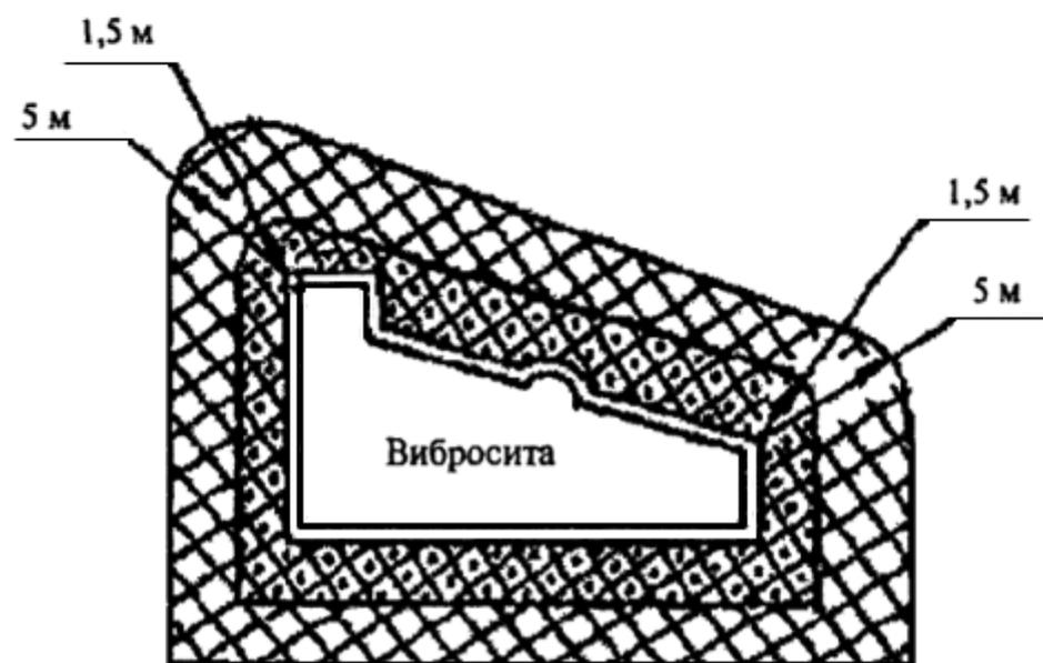
Рис.4. Открытые пространства вокруг открытых емкостей, аппаратов, устройств.
